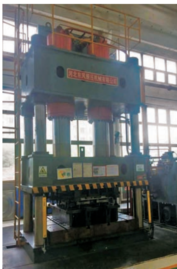
大型冲压设备
